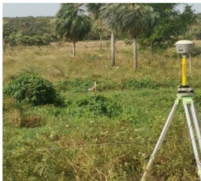
Se delimitaron los caminos con estacas de madera de 1 metro, utilizando equipos de medición topográfica de alta precisión.
